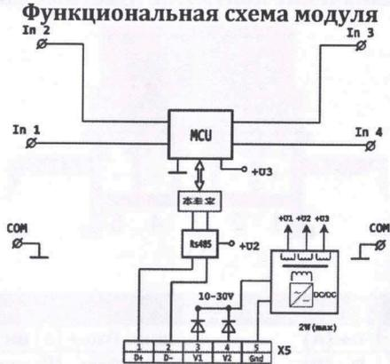
**Схема подключения питания и RS485**
