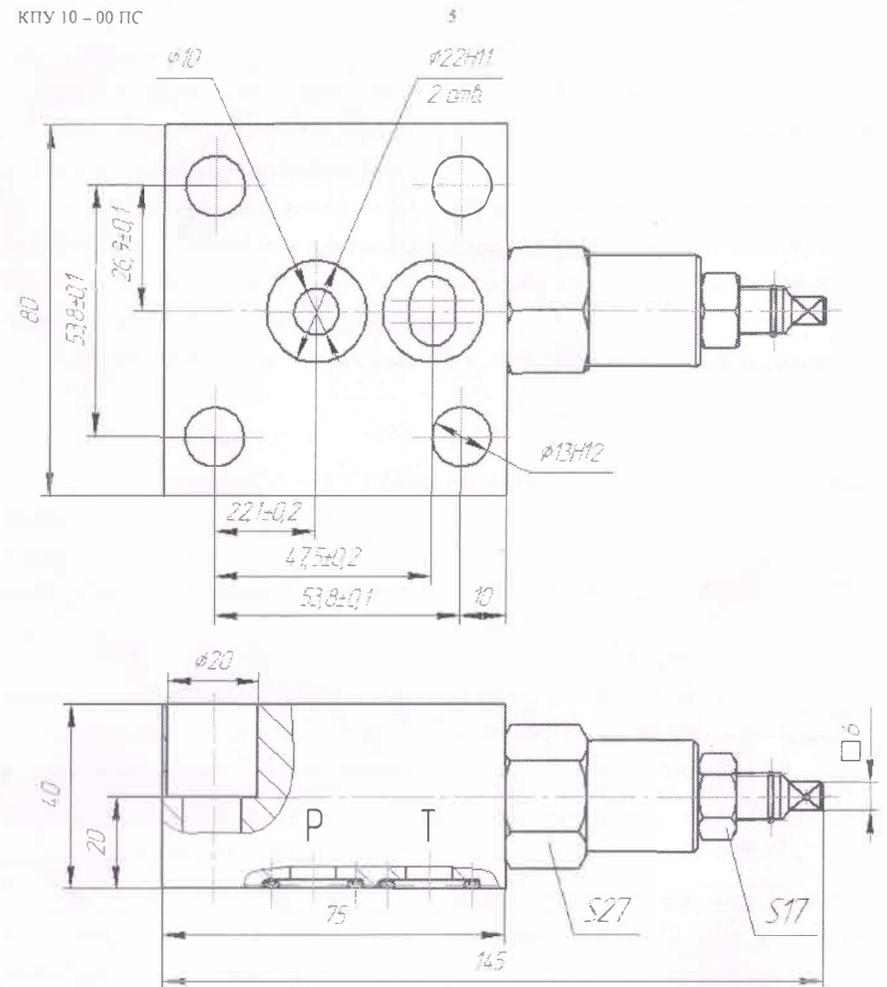
Рисунок 1.4 - Габаритные и присоединительные размеры клапана предохранительного типа КПУ 10/X C - X1
