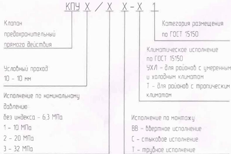
Рисунок 1.1 Условное обозначение гидроклапана предохранительного
