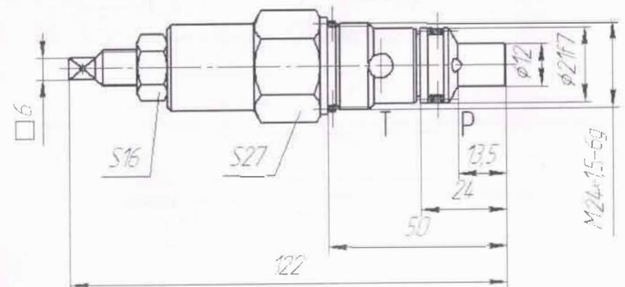
Рисунок 1.2 – Габаритные и присоединительные размеры клапана предохранительного типа КПУ 10/Х ВВ X1
