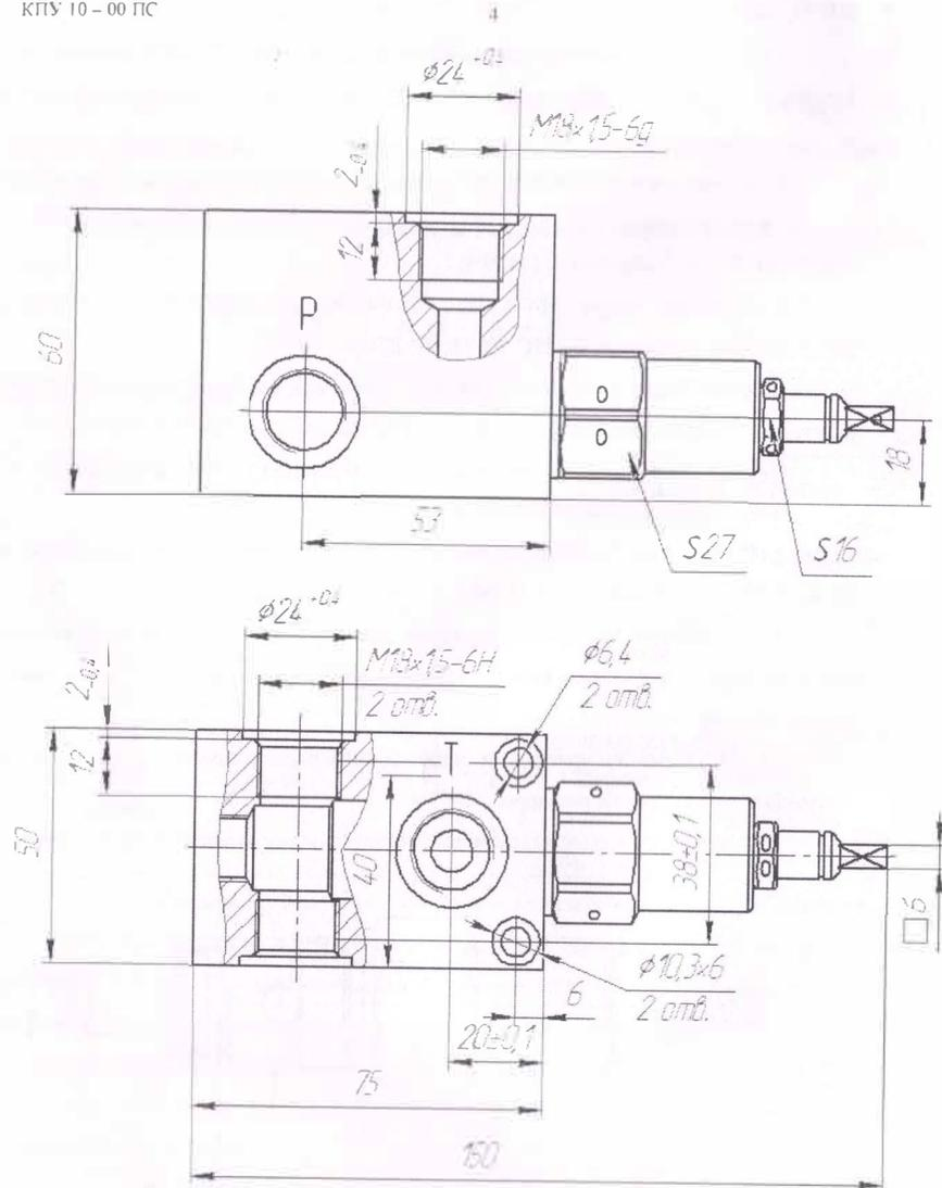
Рисунок 1.3 - Габаритные и присоединительные размеры клапана предохранительного типа КПУ 10/X T - X1
