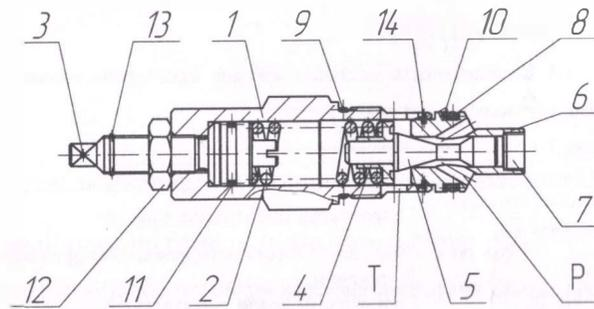
Рисунок 5.1 Конструкция клапана предохранительного
